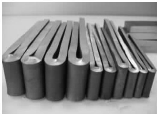
图 3 TQ550NH 热轧钢带 180° d=0 冷弯试样性能优异,能够适应铁路货车部件对热轧钢带加工性能的多样化需求。
