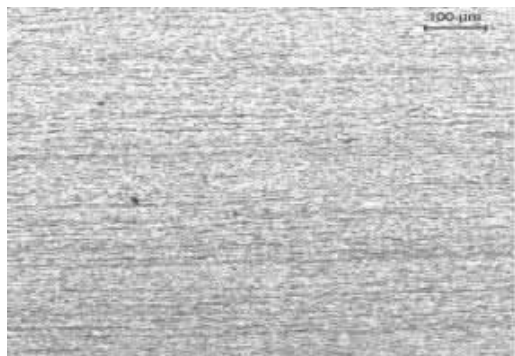
图 1 TQ550NH 高强度耐大气腐蚀热轧钢带试样的金相组织
